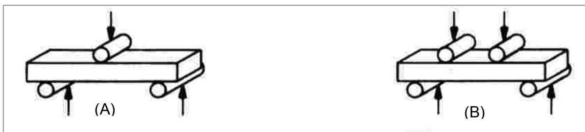
FIGURA 10: Esquema do ensaio de resistência à flexão: (A) três pontos e (B) quatro pontos.
